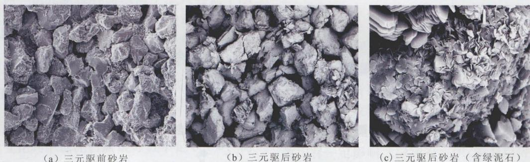
(a) 三元驱前砂岩 (b) 三元驱后砂岩 (c) 三元驱后砂岩 (含绿泥石)
